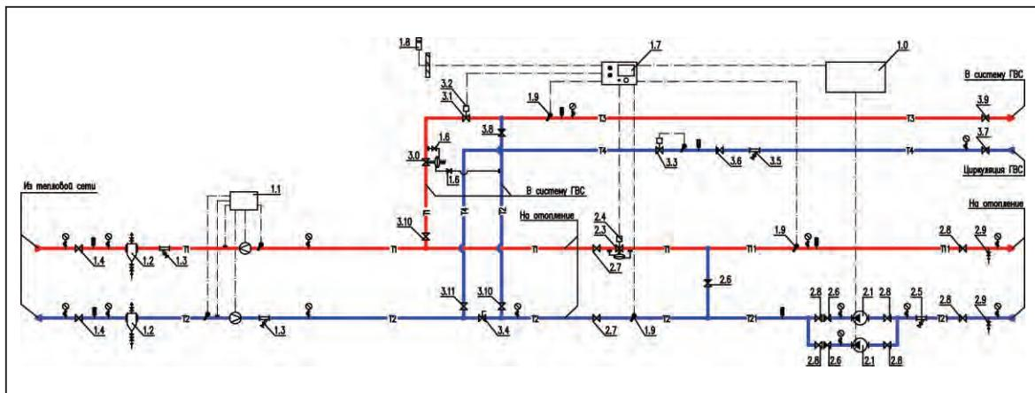
1.2. Блочный тепловой пункт с зависимой системой отопления и закрытой 2-ступенчатой системой ГВС для г. Астаны
